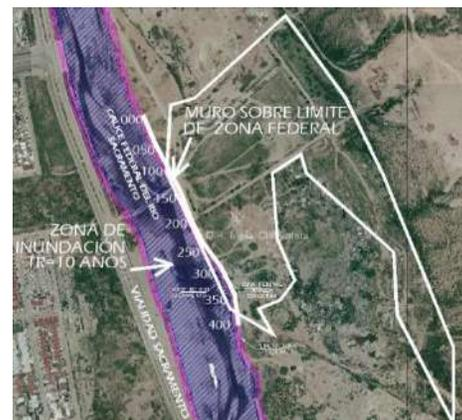
Gráfico 10. Planta de Ubicación de Muro de Contención para Límite de Zona Federal
