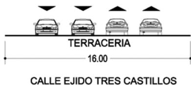
Fig. 46 Sección vial actual.<sup>57</sup>
