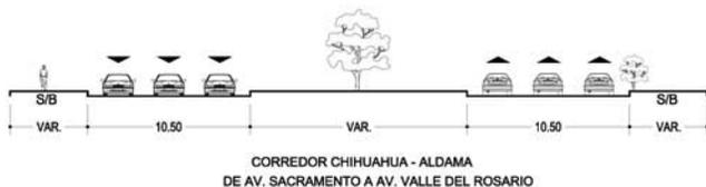
Fig. 42 Sección vial actual.<sup>53</sup>
