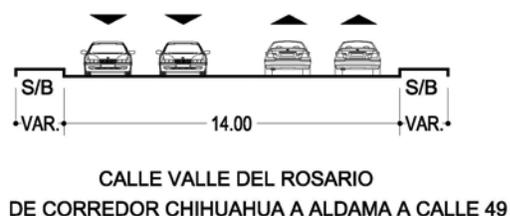
Fig. 45 Sección vial actual.<sup>56</sup>
