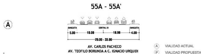
Fig. 35 Sección vial.<sup>45</sup>
