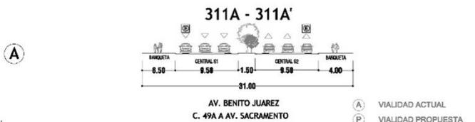
Fig. 34 Sección vial.<sup>44</sup>
