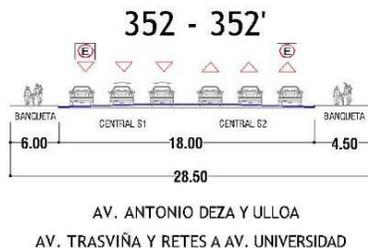
Fig. 44 Sección vial existente.<sup>54</sup>
