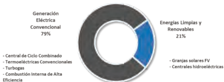
Figura 35. Capacidad de Generación Instalada
