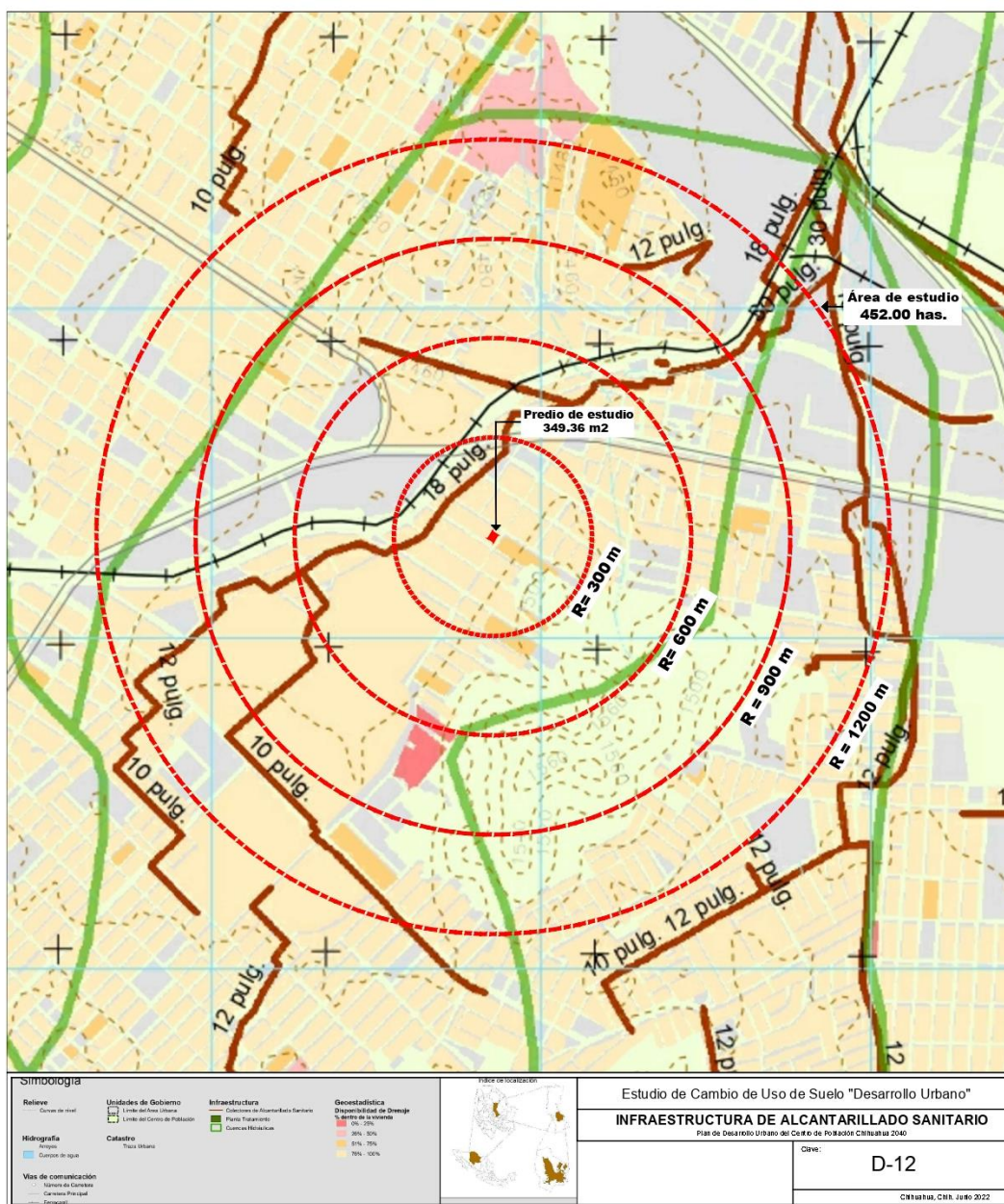
Imagen 33. Infraestructura de alcantarillado en la zona, fuente: PDU 2040
