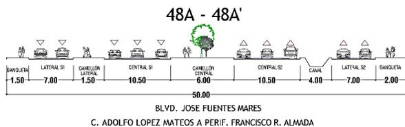
Fig. 46 Sección vial existente.<sup>56</sup>
