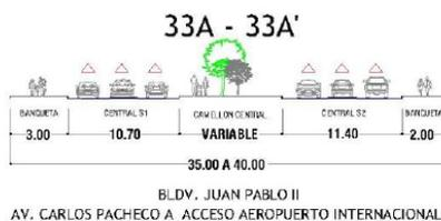
Fig. 47 Sección vial actual.<sup>57</sup>
