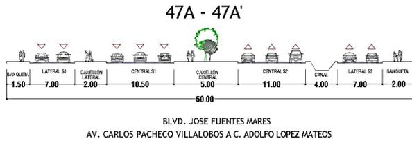
Fig. 45 Sección vial existente.<sup>55</sup>
