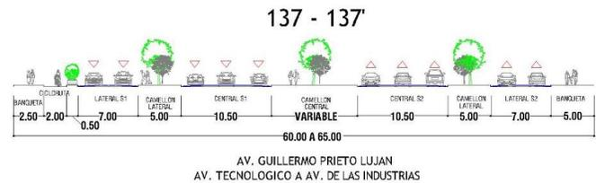
Fig. 45 Sección vial existente. 55
