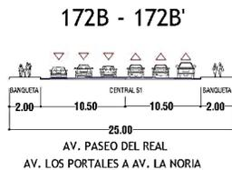
Fig. 47 Sección vial existente.<sup>57</sup>
