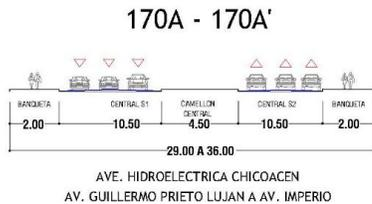
Fig. 46 Sección vial existente.<sup>56</sup>
