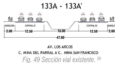
Fig. 49 Sección vial existente.<sup>59</sup>
