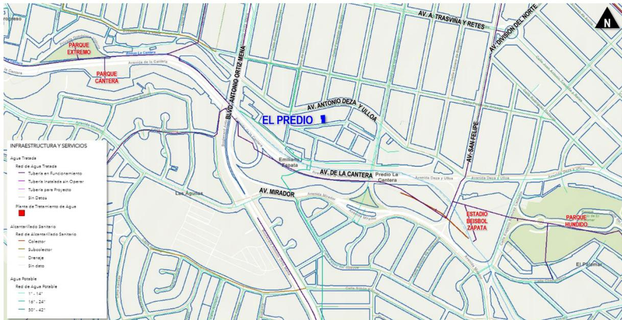
Imagen 74. Infraestructura de agua tratada, alcantarillado sanitario y agua potable en la zona inmediata al predio. Fuente: SIGMUN, octubre 2022.
