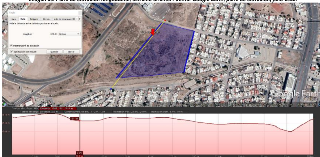
Imagen 31. Perfil de elevación longitudinal, extremo poniente. Fuente: Google Earth, perfil de elevación, julio 2022.
