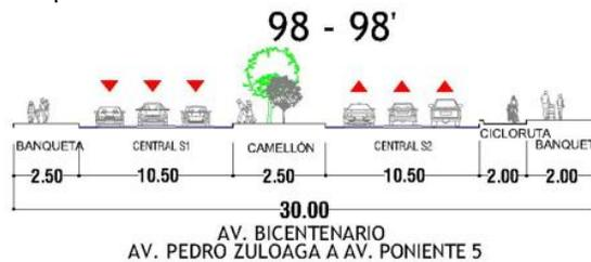
*Imagen 114. Sección Vial propuesta de la C. Bicentenario. Fuente: PDU 2040 vigente.*
