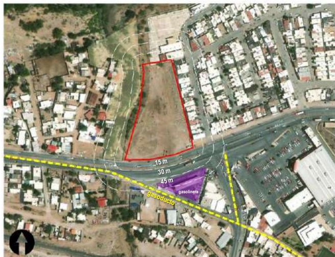
Fig. 62 Línea de gas concesionada a Ecogas en trayectoria sobre Perif. Lombardo Toledano y gasolinera. 72
