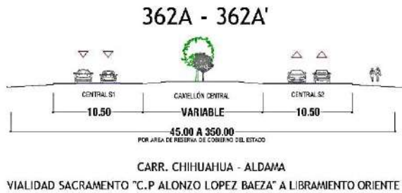
Fig. 49 Sección vial existente. 59
