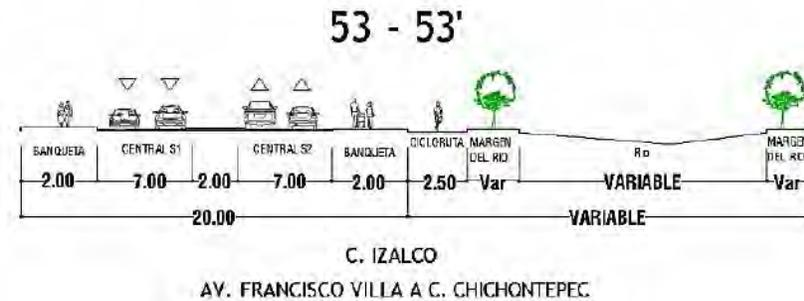
IMAGEN 87.- Sección vial calle Izalco. Fuente: PDU del centro de población Chihuahua Visión 2040.
