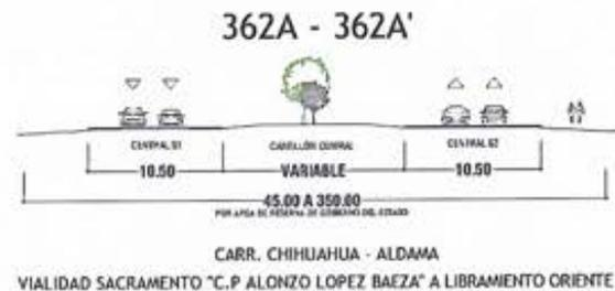
Fig. 44 Sección vial existente.<sup>54</sup>
