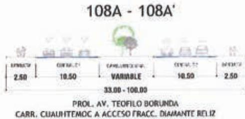
Fig. 51 Sección vial existente.<sup>61</sup>
