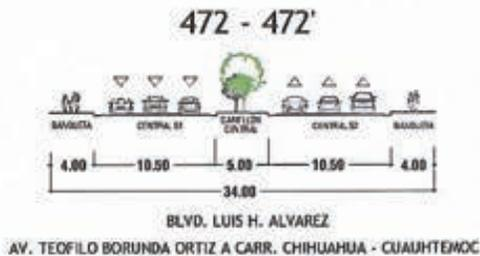
Fig. 70 Sección vial propuesta.<sup>89</sup>
