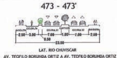
Fig. 72 Sección vial propuesta.<sup>91</sup>
