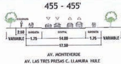
Fig. 53 Sección vial existente.<sup>63</sup>
