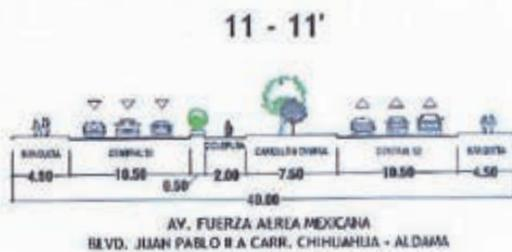
Fig. 49 Sección vial existente.<sup>59</sup>
