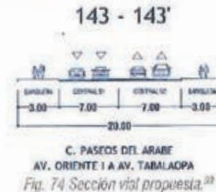
Fig. 74 Sección vial propuesta.<sup>93</sup>
