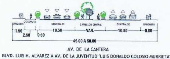
Fig. 50 Sección vial existente.<sup>60</sup>
