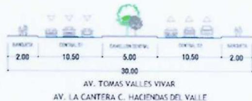
Fig. 52 Sección vial existente.<sup>62</sup>
