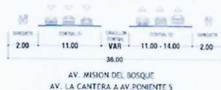
Fig. 53 Sección vial existente.<sup>63</sup>
