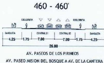
Fig. 78 Sección vial propuesta.<sup>98</sup>
