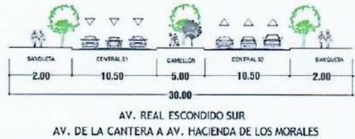
Fig. 51 Sección vial existente.<sup>61</sup>
