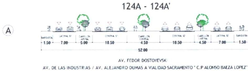
Imagen 45. Sección vial actual Av. Fedor Dostoyevski. Fuente PDU 2040 vigente.
