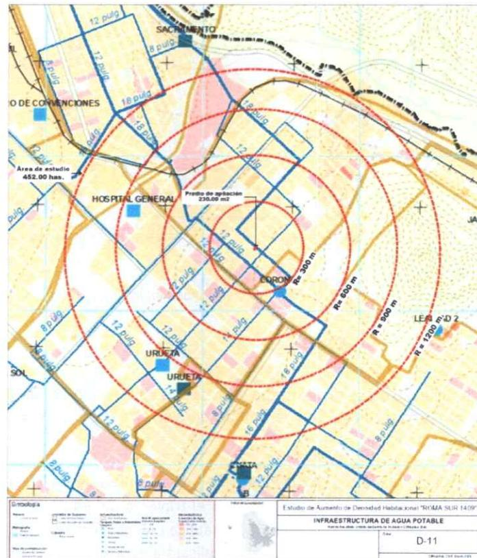
Imagen 31. Infraestructura de agua potable en la zona, fuente: PDU 2040
