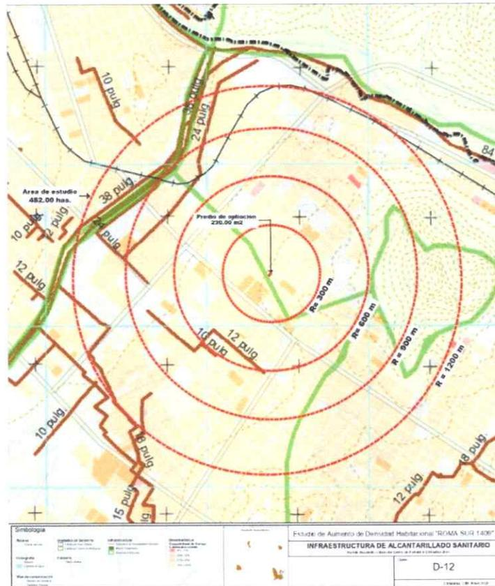
Imagen 32. Infraestructura de alcantarillado en la zona, fuente: PDU 2040
