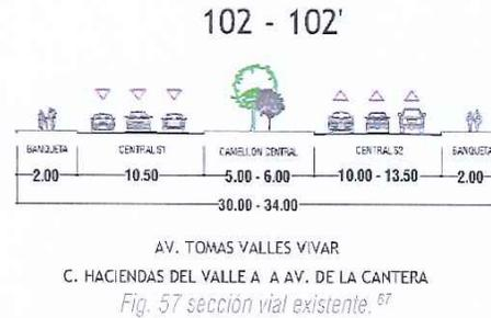
Fig. 57 sección vial existente.<sup>67</sup>
