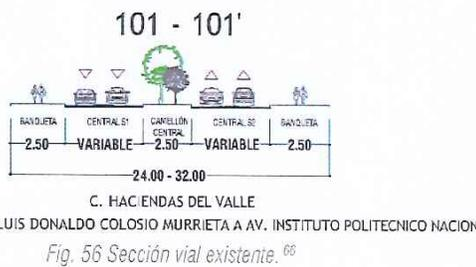
Fig. 56 Sección vial existente.<sup>66</sup>
