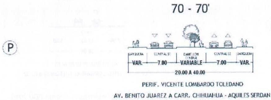
Figura 91 – Sección vial actual y propuesta para Periférico Vicente Lombardo Toledano. Fuente PDU 2040.
