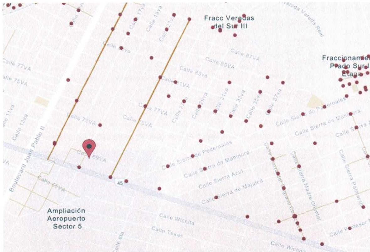
Figura 109 – Red de Alcantarillado Sanitario, indicando coladeras y brocales en color café. Fuente SIGMUN.
