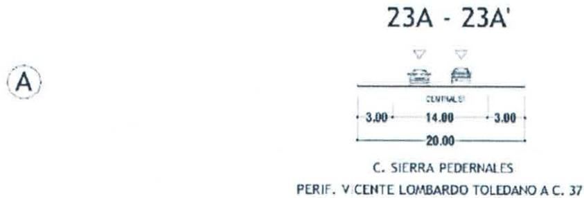
Figura 93 – Sección vial actual para calle Sierra Pedernales. Fuente PDU 2040.
