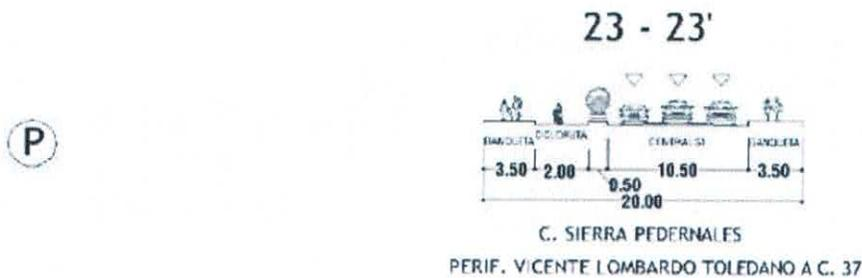
Figura 94 – Sección vial propuesta para calle Sierra Pedernales. Fuente PDU 2040
