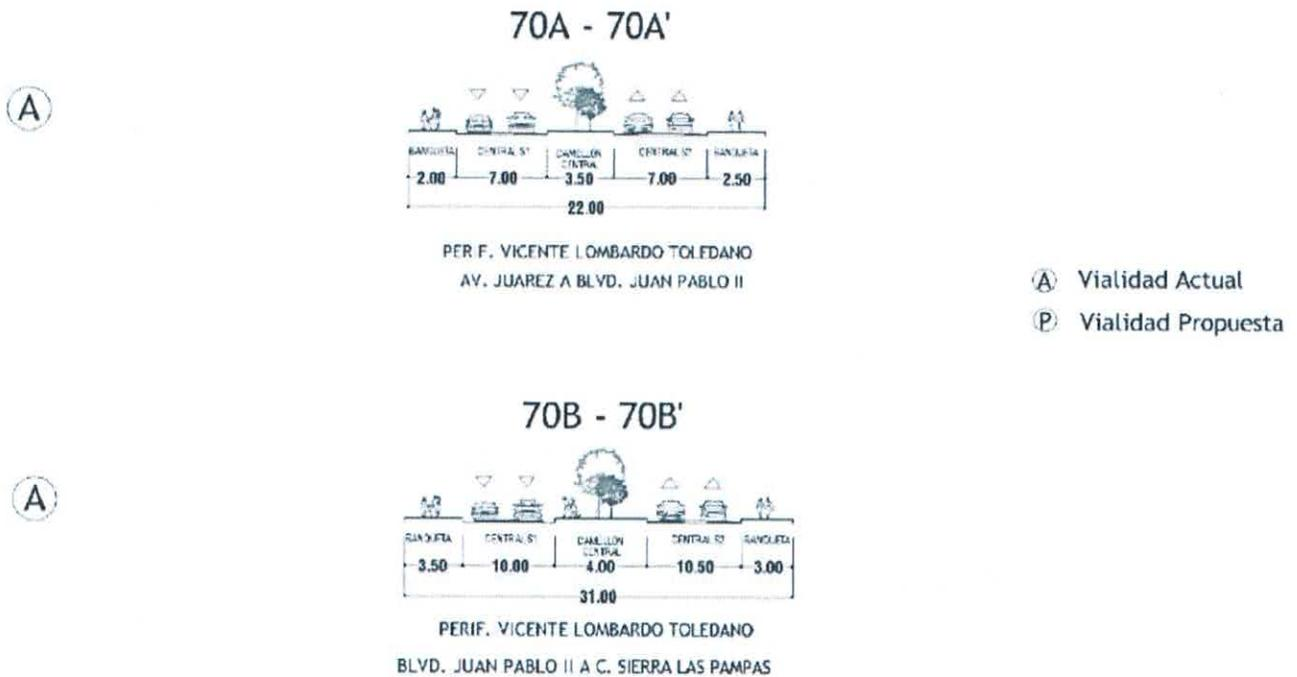
Figura 90 - Secciones viales actuales para Periférico Vicente Lombardo Toledano. Fuente PDU 2040.
