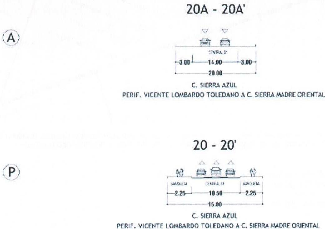
Figura 96 – Sección vial propuesta para calle Sierra Azul. Fuente PDU 2040.
