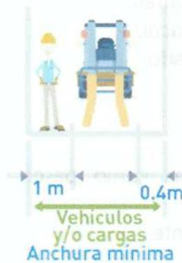
Para el caso de vías mixtas de vehículos en un solo sentido y peatonales en sentido único, la anchura mínima será la del vehículo o carga incrementada en 1 metro, más una tolerancia de maniobra de 0,40 metros.
