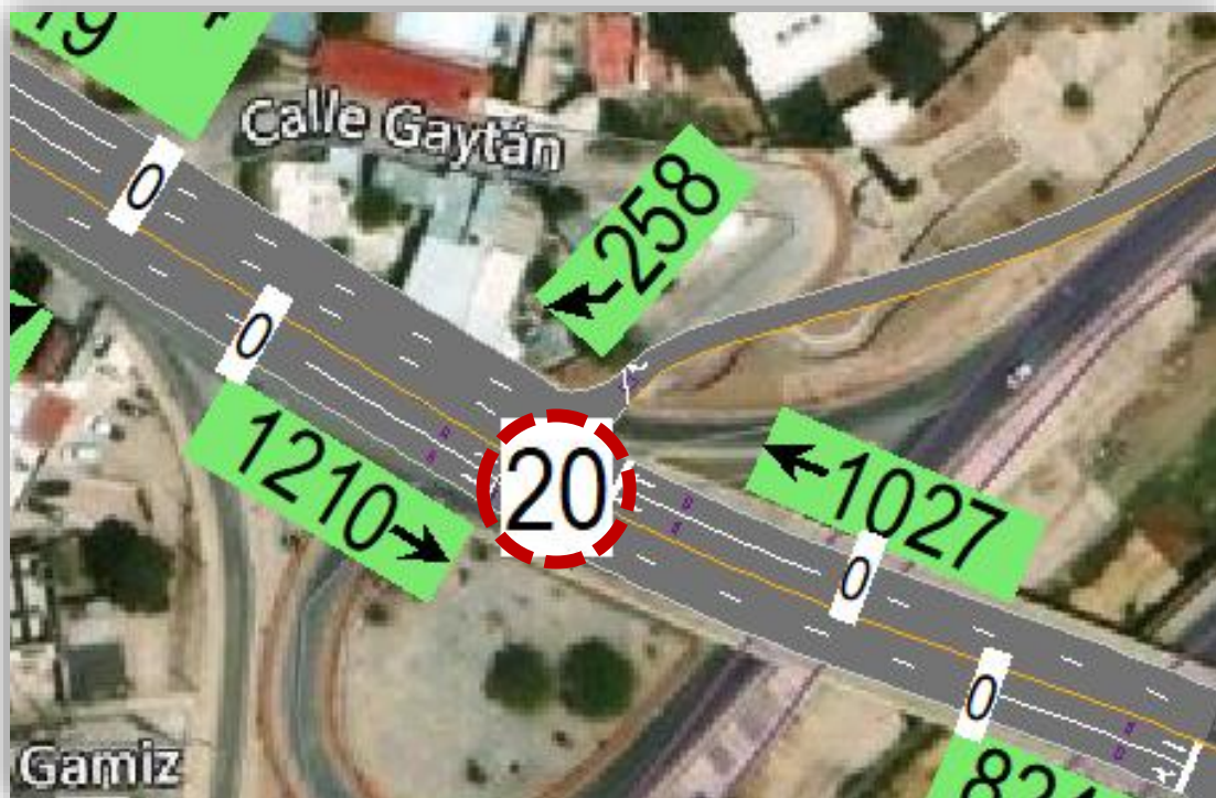
Movimiento direccional de aforo vehicular Carril de incorporación de la Av. Teófilo Borunda a la Av. Presa de Tecamatlán - NODE 20
