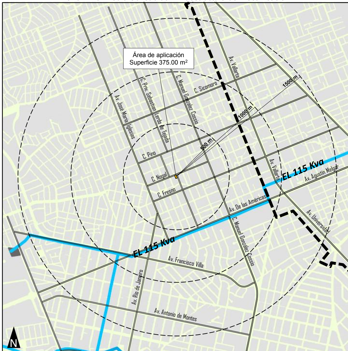
Plano D-13: Medio Construido: Infraestructura de Electrificación.
